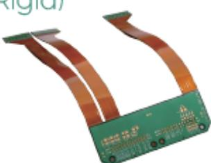
WISE PCB의 플렉스 리지드 PCB는 유연성과 견고함을 결합한 구조로, 복잡한 3D 설계와 소형화된 디바이스에 최적화되어 있습니다. 유연한 부분은 구부리거나 접을 수 있어 공간 활용을 극대화하며, 견고한 리지드 부분은 높은 안정성과 신뢰성을 제공합니다. 뛰어난 내구성과 전기적 성능 덕분에 소비자 전자, 의료기기, 항공우주 등 다양한 산업에서 활용되고 있습니다. WISE PCB의 협력업체는 혁신적인 설계 솔루션과 품질을 보장합니다.
