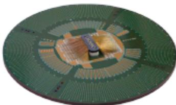
WISE PCB는 고정밀 Probe Card 제작을 위해 정밀 가공 기술, 초미세 회로 설계, 및 고도의 신호 무결성 관리 기술을 보유하고 있습니다. Probe Card는 반도체 테스트에 사용되며, 고주파 신호 처리와 미세 핀 배열을 지원해야 하기 때문에 높은 품질 기준이 요구됩니다. WISE PCB는 엄격한 품질 관리와 최신 기술을 활용하여 고객 요구에 맞는 맞춤형 Probe Card를 제공합니다.
